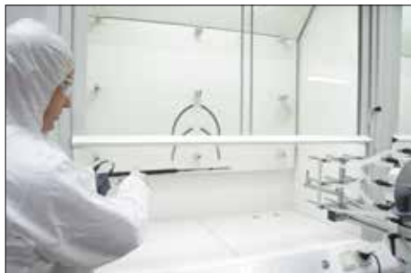
Réalisation du test de confinement : introduction du traceur SF6
