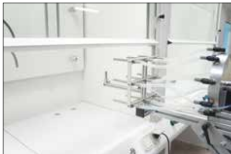
Réalisation du test de confinement : introduction du traceur SF6
