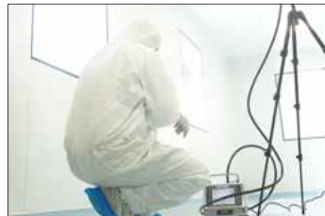
Réalisation du test de confinement : comptage particulaire
